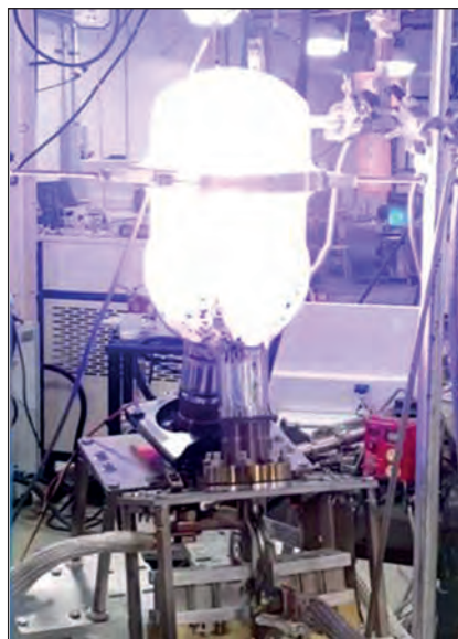
Eines der ersten funktionierenden SunCell-Systeme, das mit Argon und Wasserstoff knapp über normalem Atmosphärendruck betrieben wurde. Mithilfe von Konzentratorzellen kann damit Elektrizität erzeugt werden.
