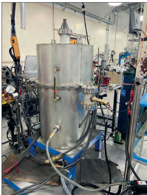
Kompletter SunCell-Dampfkessel mit automatisiertem Wasserzuführungssystem
